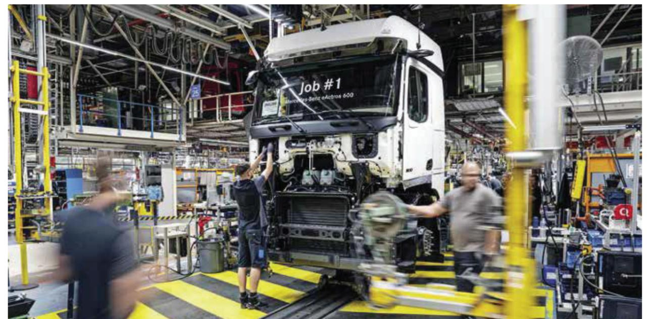
**FERNVERKEHR** Beim eActros 600 wird erstmals der komplette Bau in einer Produktionshalle erledigt.
