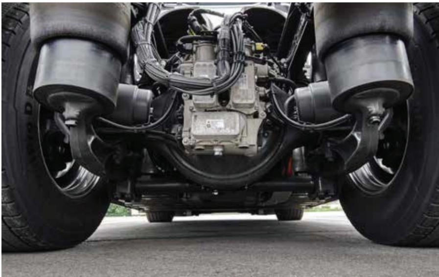
**E-ACHSE** Mit zwei Elektromotoren und automatisiertem Vierganggetriebe.
